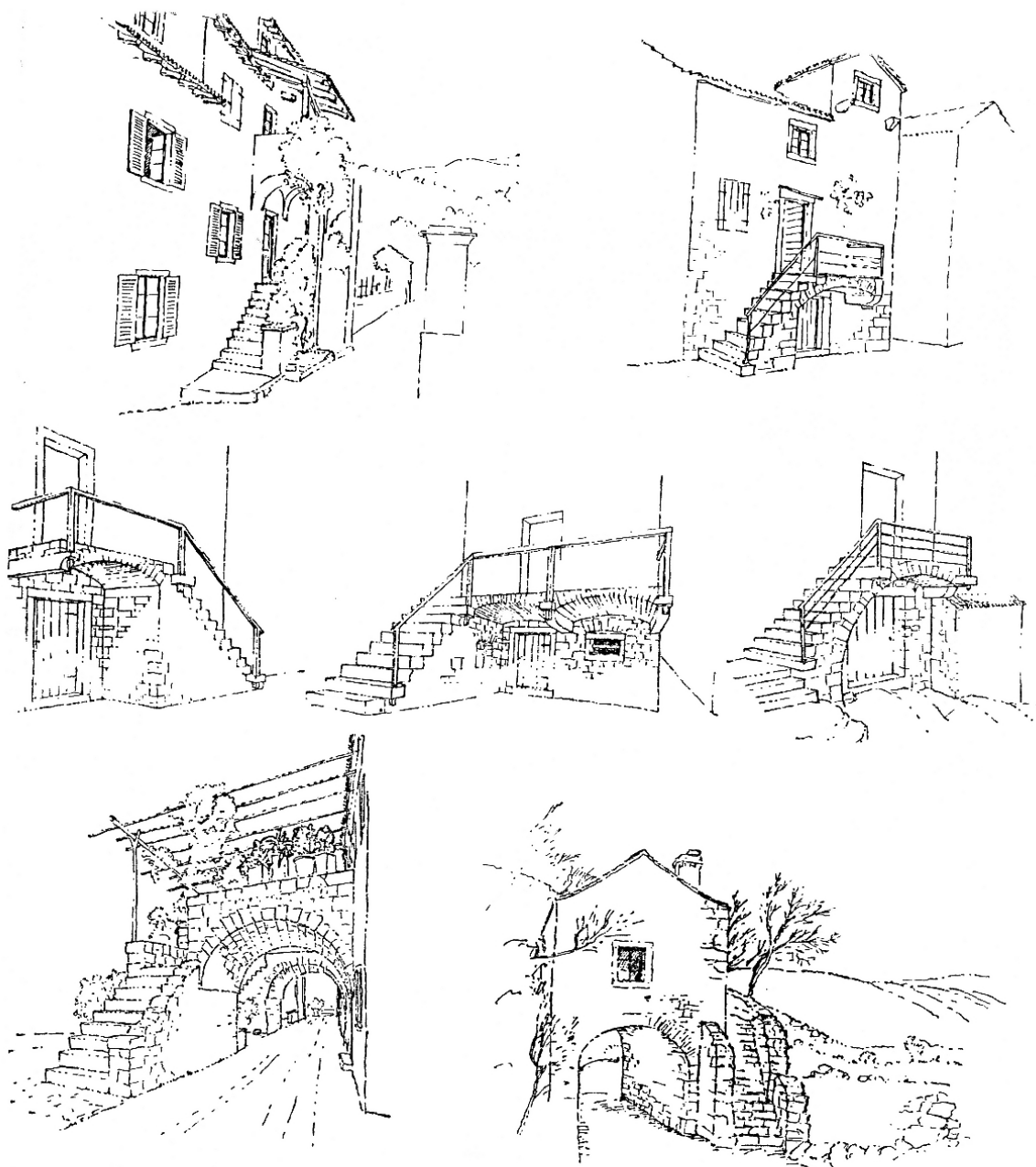
Slika 8: Stopnice v suhozidu
